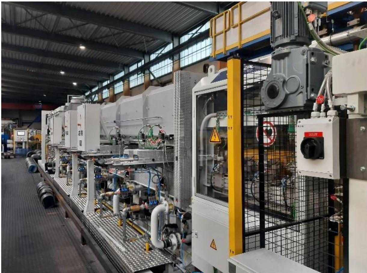
Blockofen und Bolzenvorwärmung von extrutec bei apt im Einsatz: Nachhaltigkeit, Qualität und Effizienz stehen im Fokus des energieoptimierten Erwärmungsprozesses
